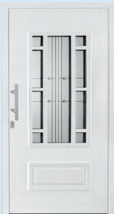
Kunststoff Modell 20459 (PG43) Aluminium Modell 40459 (PG60) Variante: Kontur, mit äußerem Vollblatt-Design 3fach-Glas: Designglas „Montevideo“ Klarglas mit Teilmattierung und klaren Facettensteinen Griff: HA1039-40 Edelstahl PZ-Rosette: HA1075 Edelstahl (oval)
