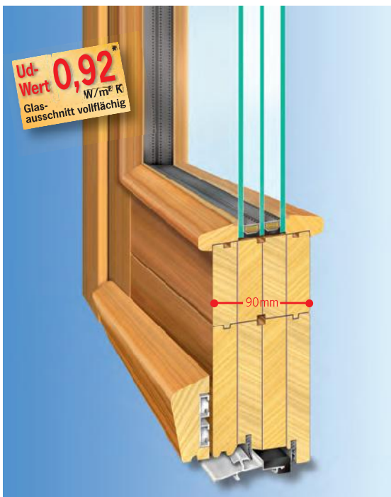
PrimeDoor 9.0 Royal Classic Holz-Haustüren beidseitig mit überfälzten, glatten Glasleisten und Wasserschenkel Bautiefe 90 mm
